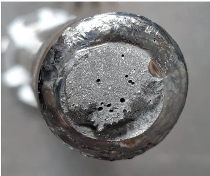
◀ Bild 5. Massive Bindefehler am Rand aufgrund von kaltem Eintauchen, Schweißzone versagt bei geringer Belastung
