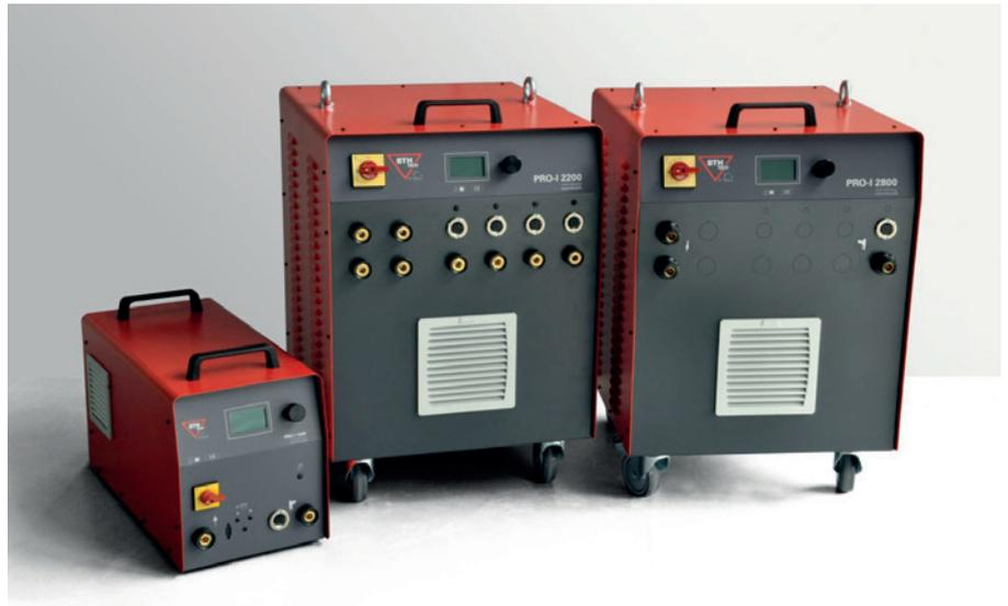
▲ Bild 7. Inverter-Stromquellen der Serie „Pro-I“
